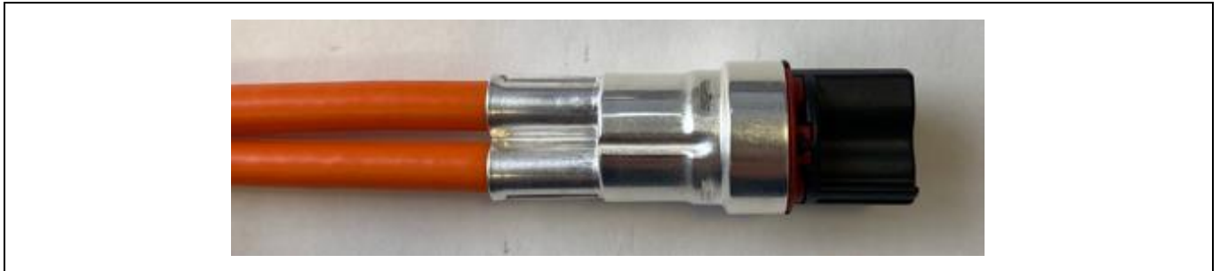
Abbildung 4.26 Darstellung 6,0 mm 2 SCC Schirmhülse verpressen (4.9 Schirmhülse verpressen)
