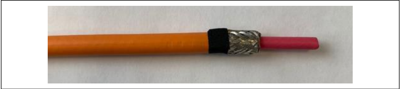
Abbildung 3.13 Darstellung 4,0 mm 2 SCC Schirmgeflecht umlegen und fixieren (3.5 Schirmgeflecht umlegen und Schirmgeflecht fixieren)
