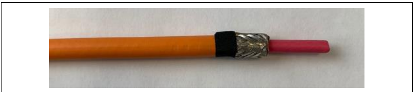
Abbildung 3.18 Darstellung 4,0 mm 2 SCC überstehendes Schirmgeflecht positionieren (3.5 Schirmgeflecht umlegen und Schirmgeflecht fixieren)
