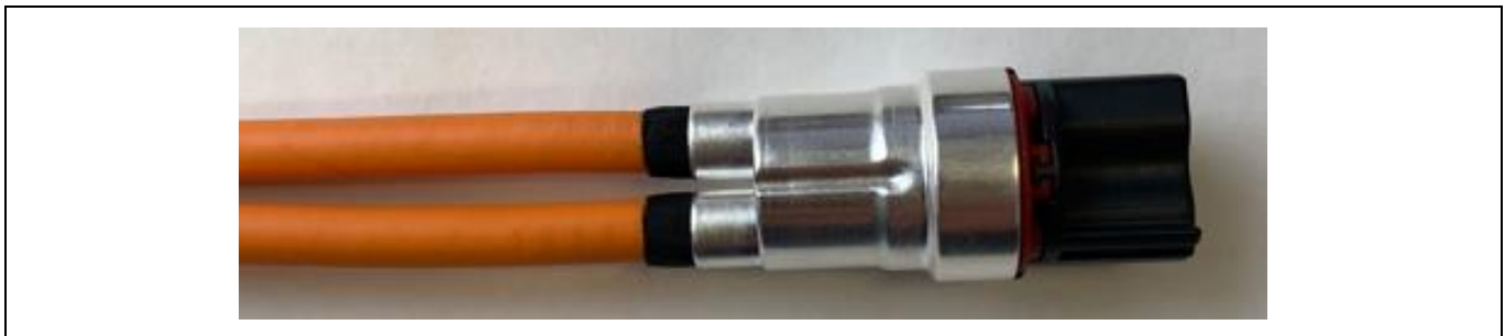
Abbildung 3.33 Darstellung 4,0 mm 2 SCC Überstehendes Tape (3.9 Schirmhülse auf Kontaktträger schieben)
