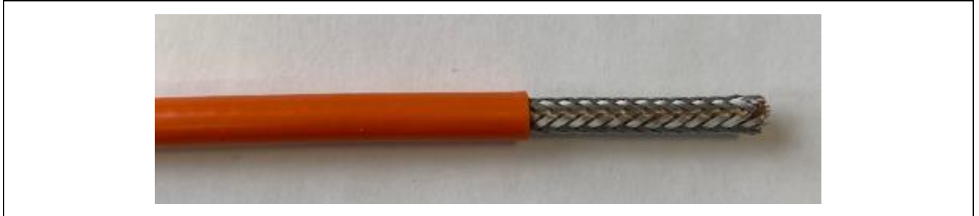
Abbildung 4.6 Darstellung 6,0 mm 2 SCC Maß D16 (4.3 Leitung abmanteln)
