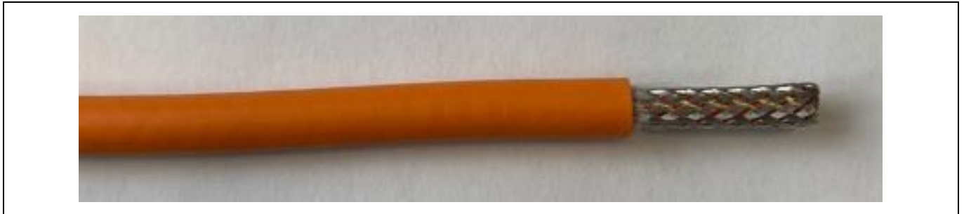
Abbildung 3.6 Darstellung 4,0 mm 2 SCC Maß D1 (3.3 Leitung abmanteln)
