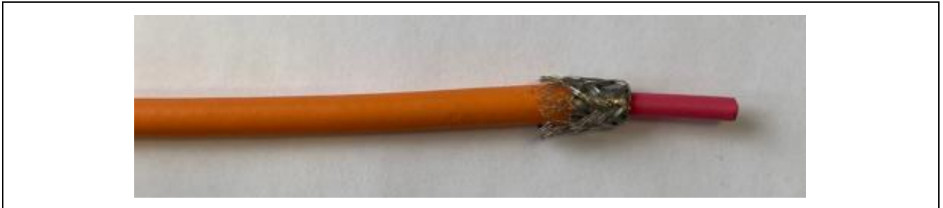
Abbildung 3.14 Darstellung 4,0 mm 2 SCC geschirmtes Schirmgeflecht (3.5 Schirmgeflecht umlegen und Schirmgeflecht fixieren)
