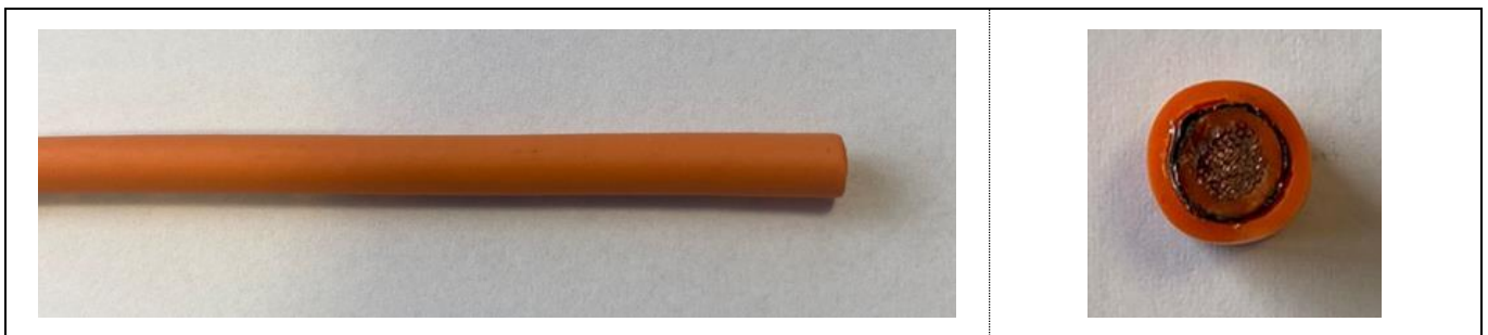
Abbildung 4.1 Darstellung 6,0 mm 2 SCC-Leitungsbeispiel (4.1 Leitung schneiden)
