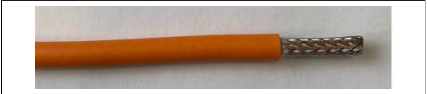
Abbildung 3.6 Darstellung 4,0 mm 2 SCC Maß D1 (3.3 Leitung abmanteln)
