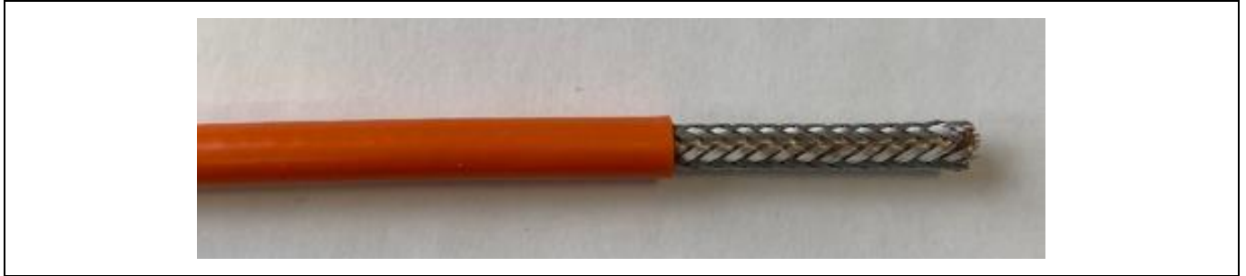
Abbildung 4.6 Darstellung 6,0 mm 2 SCC Maß D16 (4.3 Leitung abmanteln)
