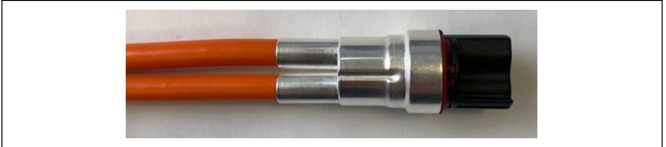
Abbildung 4.20 Darstellung 6,0 mm 2 SCC Schirmhülse auf Kontakträger schieben (4.8 Schirmhülse auf Kontakträger schieben)
