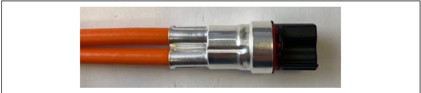
Abbildung 4.26 Darstellung 6,0 mm 2 SCC Schirmhülse verpressen (4.9 Schirmhülse verpressen)
