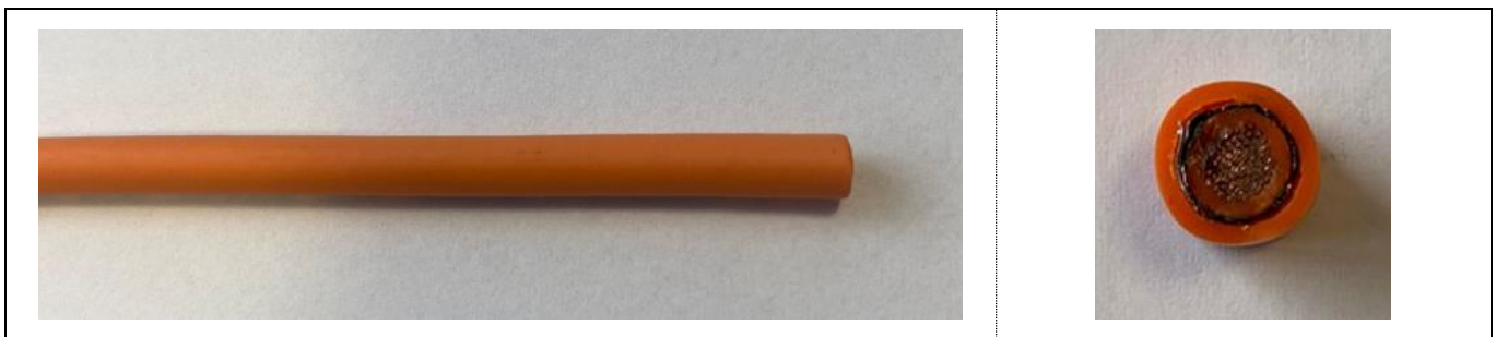
Abbildung 4.1 Darstellung 6,0 mm 2 SCC-Leitungsbeispiel (4.1 Leitung schneiden)
