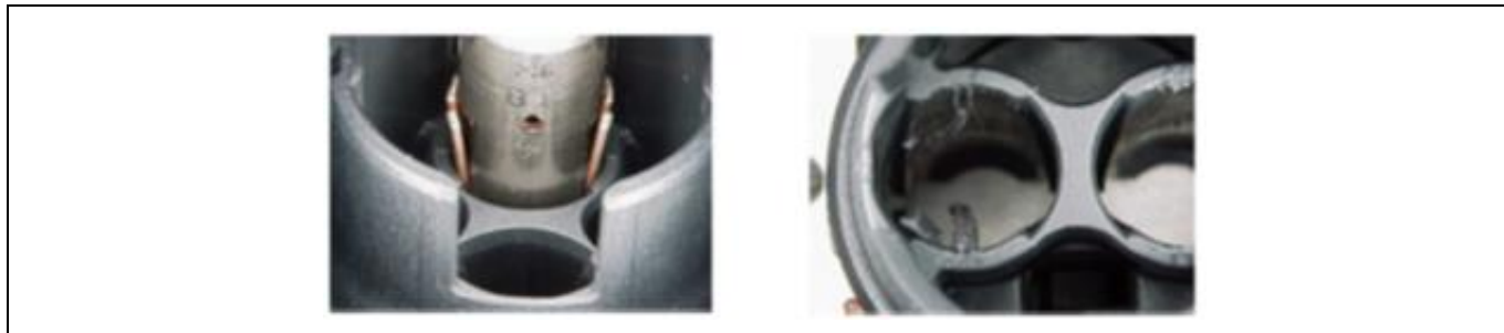
Abbildung 4.17 Darstellung 6,0 mm 2 SCC Kunststoffgrat am Kontaktträger (4.6 HCT4 Buchsenkontakte in Kontaktträger bestücken)
