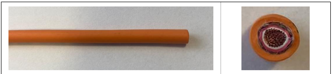
Abbildung 3.1 Darstellung 4,0 mm 2 SCC Leitung Beispiel (3.1 Leitung schneiden)
