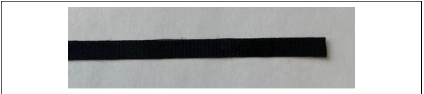
Abbildung 3.16 Darstellung 4,0 mm 2 SCC 5,0 Fixierband (3.5 Schirmgeflecht umlegen und Schirmgeflecht fixieren)
