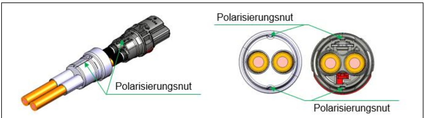
Abbildung 4.22 Darstellung 6,0 mm 2 SCC Polarisierung Schirmhülse und Kontakträger (4.8 Schirmhülse auf Kontakträger schieben)
