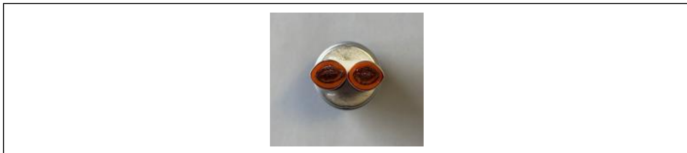
Abbildung 4.32 Darstellung 6,0 mm 2 SCC Maß D25 (4.9.1 Leitungsschirmverpressung mittels zwei Halbschalen)
