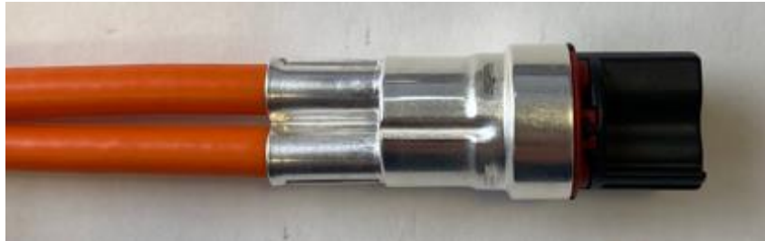
Abbildung 4.26 Darstellung 6,0 mm 2 SCC Schirmhülse verpressen (4.9 Schirmhülse verpressen)
