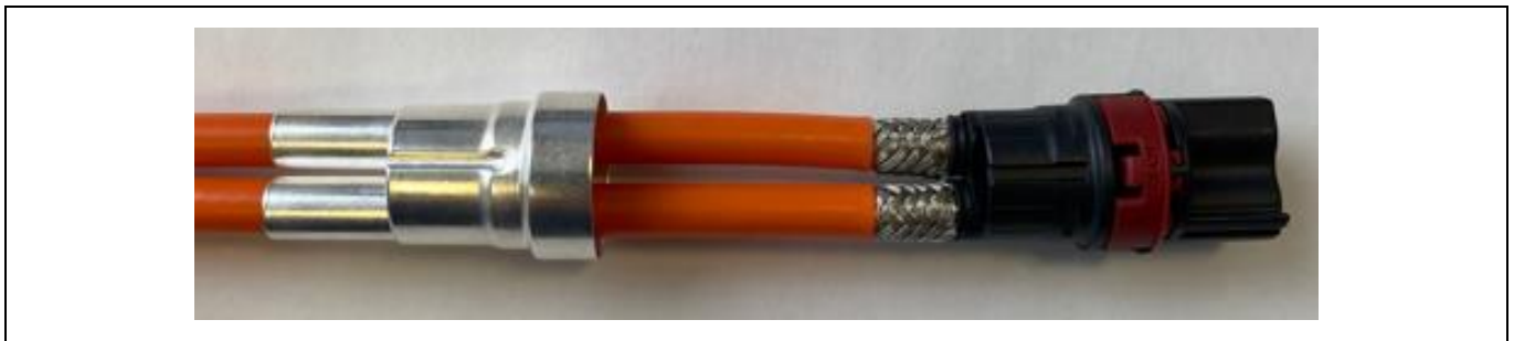
Abbildung 4.24 Darstellung 6,0 mm 2 SCC Überstehende einzelne Abschirmlitzen (4.8 Schirmhülse auf Kontaktträger schieben)
