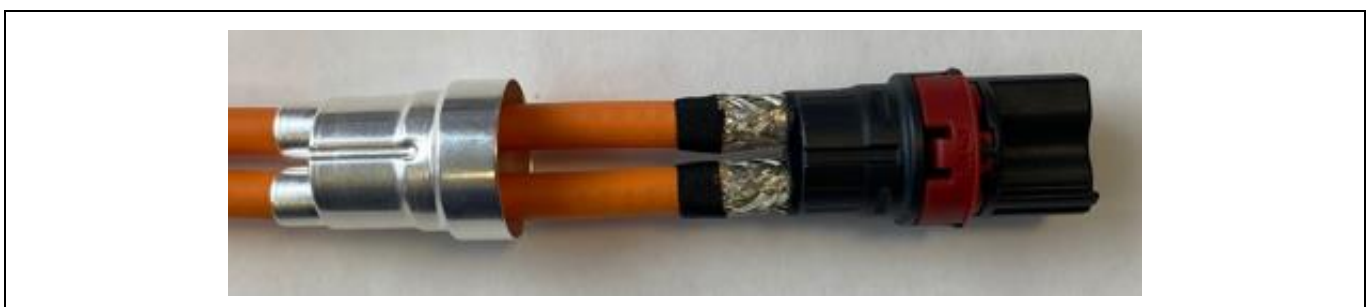
Abbildung 3.34 Darstellung 4,0 mm 2 SCC Überstehende einzelne Abschirmlitzen (3.9 Schirmhülse auf Kontaktträger schieben)
