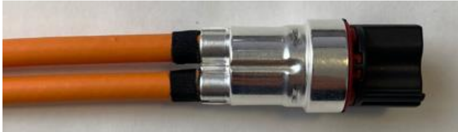
Abbildung 3.35 Darstellung 4,0 mm 2 SCC Schirmhülse verpressen (3.10 Schirmhülse verpressen)
