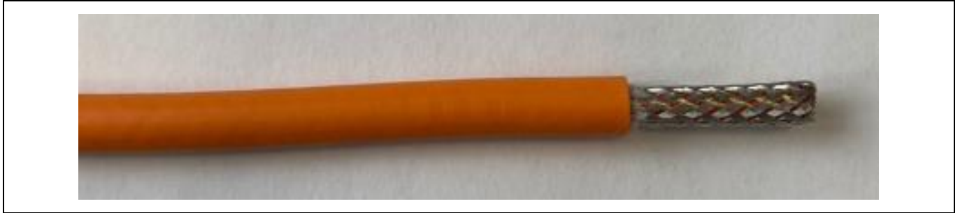
Abbildung 3.6 Darstellung 4,0 mm 2 SCC Maß D1 (3.3 Leitung abmanteln)
