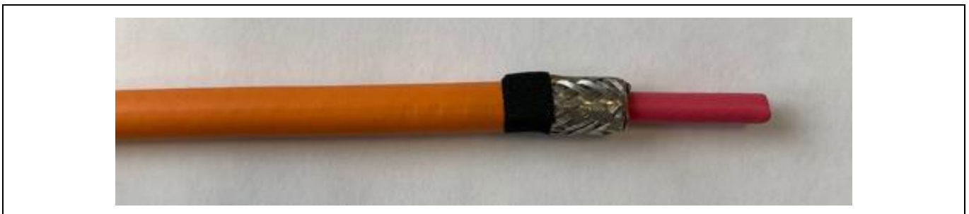
Abbildung 3.15 Darstellung 4,0 mm 2 SCC fixieren Schirmgeflecht (3.5 Schirmgeflecht umlegen und Schirmgeflecht fixieren)
