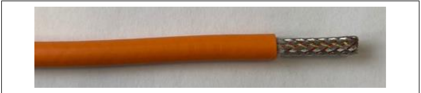
Abbildung 3.6 Darstellung 4,0 mm 2 SCC Maß D1 (3.3 Leitung abmanteln)
