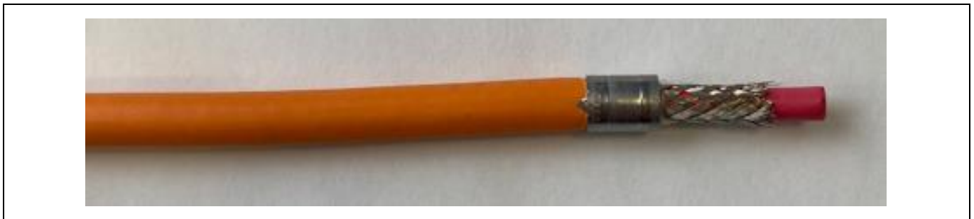
Abbildung 3.7 Darstellung 4,0 mm 2 SCC Schirmfolie entfernen (falls vorhanden), Schirmgeflecht kürzen und Mantelcrimp crimpen (3.4 Schirmfolie entfernen (falls vorhanden), Schirmgeflecht kürzen und Mantelcrimp crimpen)
