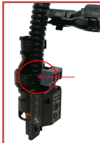
Wellrohr darf Verfahrweg des Kontaktträger nicht blockieren.
