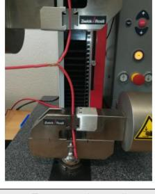
Test setup longitudinal pull
